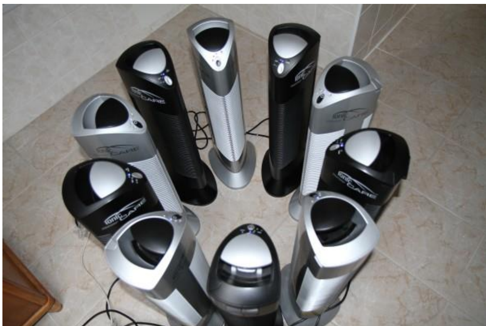
1. Měření bylo provedeno při provozu 10 čističek vzduchu Ionic-CARE Triton X6 umístěných do kruhu.
